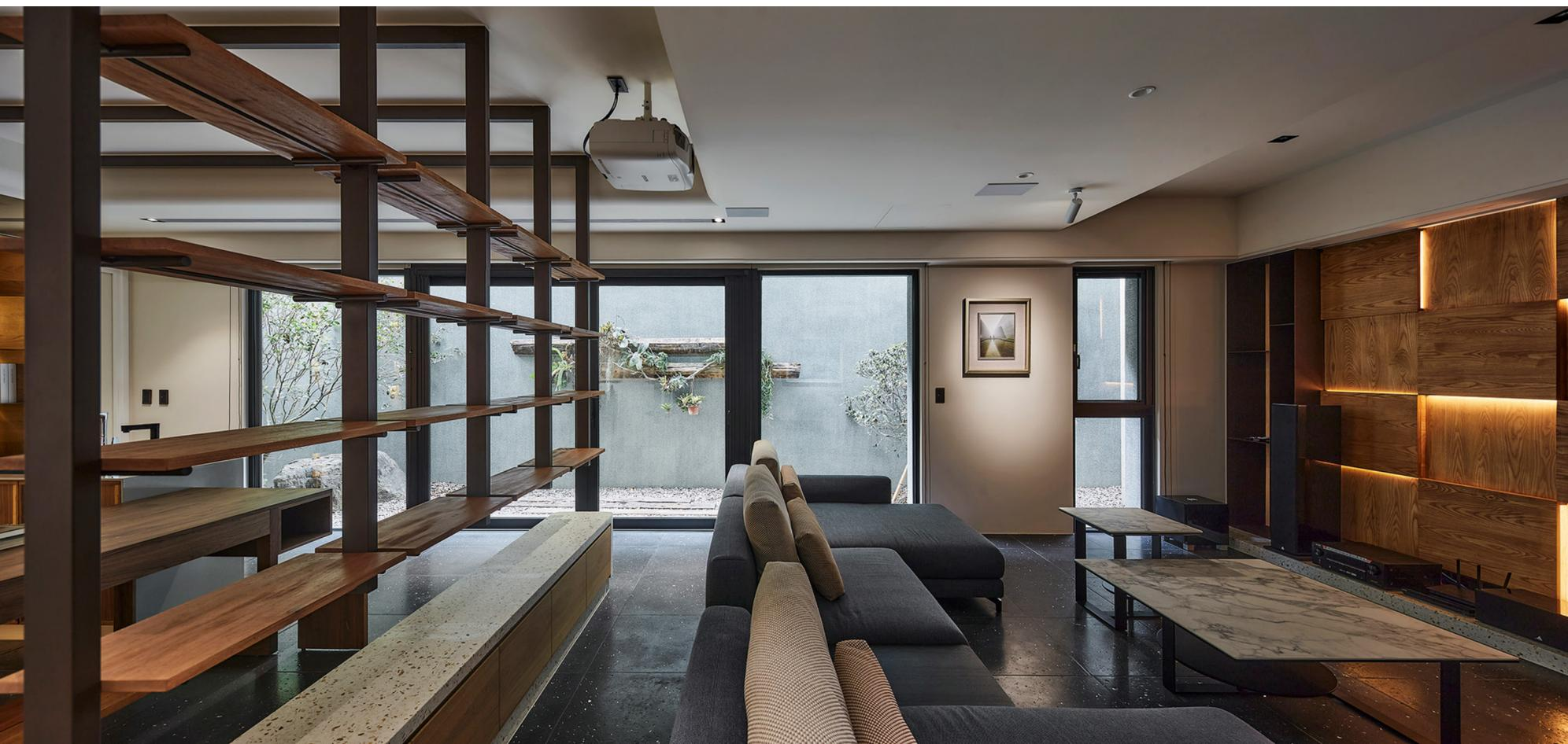
由書房上方延伸至視聽室後方的懸吊鐵件，位於空間的正中央，可以擺放書籍和藝術品，虛擬的分隔場域的同時，也創造視覺的通透性，其下方的木質收納櫃，採用水磨石包覆，形塑出厚重沉穩效果；前方電視牆由20片實木板凹凸進退所組成，利用精密的音響學計算，以減低音響播放時產生的反射音，並利用進退的縫隙嵌入LED燈條，使牆面表情更顯豐富。
